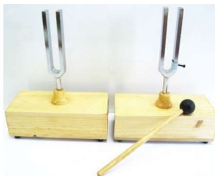
Рис. 3. Камертон на резонаторном ящике
