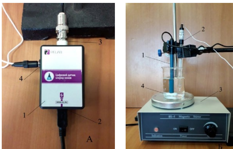
Рис. 2. Установка для определения концентрации (активности) хлорид-ионов в растворе. А: 1 — корпус датчика для определения \text{Cl}^- -ионов; 2 — разъём Micro USB для подключения к компьютеру; 3 — разъём BNC для подключения рабочего электрода; 4 — разъём для подключения электрода сравнения. Б: 1 — ионоселективный электрод (рабочий электрод); 2 — электрод сравнения (хлорсеребряный электрод); 3 — магнитная мешалка; 4 — якорь магнитной мешалки
